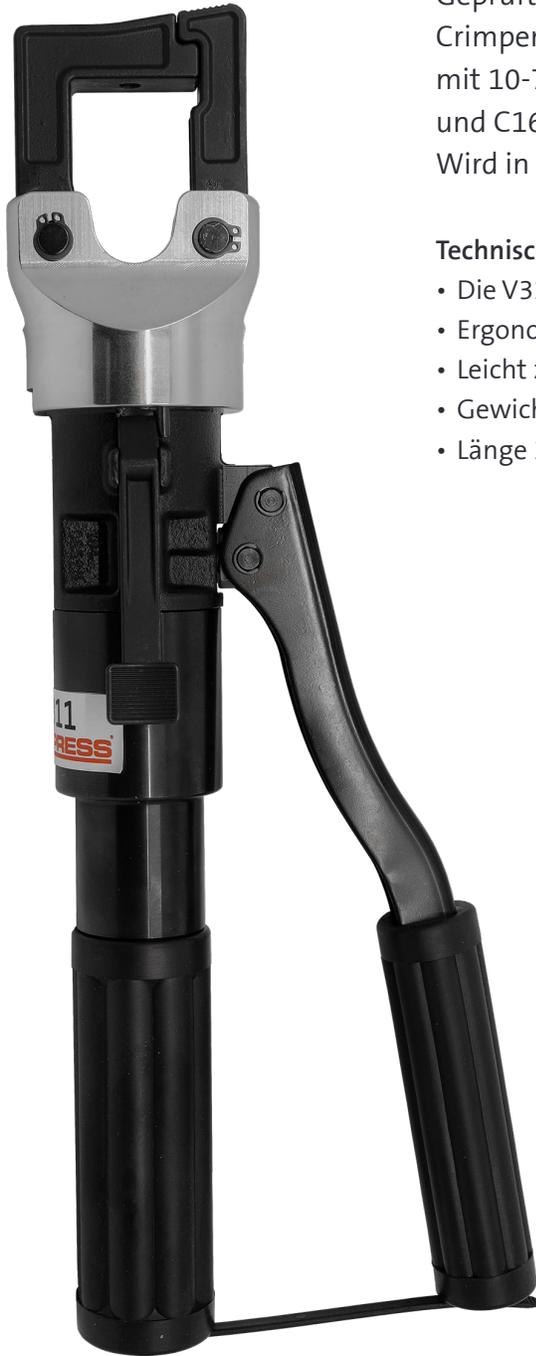
Geprüfte und zertifizierte hydraulische Handcrimpzange zum Crimpen von Cu-Verbindern vom Typ KR/KS, KRF/KSF und KRT/KST mit 10-70 mm<sup>2</sup>, KRD/KSD mit 10-95 mm<sup>2</sup> und C-Hülsen C6-10 und C16-25. Schnellvorschub für besonders effektives Crimpen. Wird in Kombination mit MB-Pressbacken verwendet.
